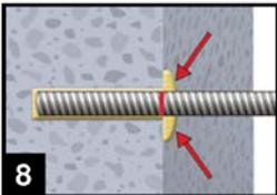
8. Nach Installation des Ankers sicherstellen, dass sich die Setztiefenmarkierung an der Bohrlochoberfläche befindet und der Ringspalt komplett mit Mörtel ausgefüllt ist. Tritt keine Masse nach Erreichen der Setztiefe heraus, ist diese Voraussetzung nicht erfüllt und die Anwendung muss vor Beendigung der Verarbeitungszeit wiederholt werden. Bei Überkopfmontage ist der Bewehrungsstab zu fixieren (z.B.
