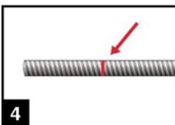
4. Vor dem Injizieren des Mörtels ist die Setztiefe auf dem Bewehrungsstab markieren (z.B. mit Klebeband). Danach den Bewehrungsstab in das leere Bohrloch einführen, um die korrekte Bohrlochtiefe  $l_v$  zu überprüfen.
