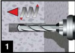
1. Bohrloch mit dem Durchmesser und der Bohrtiefe entsprechend des gewählten Bewehrungs Eisens mit Hammerbohrer (HD) oder Druckluftbohrer (CD) in den Untergrund bohren.
