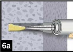
6. Gereinigtes Bohrloch vom Bohrlochgrund her ca. zu 2/3 mit Verbundmörtel befüllen. Langsames Zurückziehen des Statikmischers aus dem Bohrloch verhindert die Bildung von Luftpneumaten. Für Setztiefen größer 190 mm passende Mischerverlängerung verwenden.
