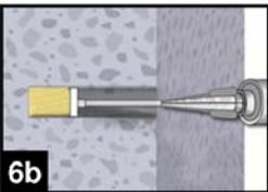
Für die Horizontal- oder Überkopfmontage sowie bei Bohrlöchern tiefer als 240mm sind Verfüllstützen zu verwenden.
